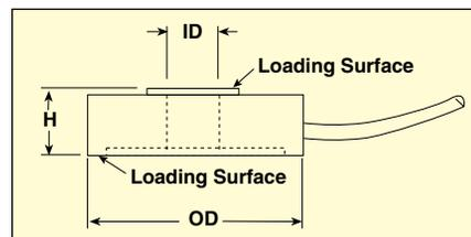
LC8300 ワッシャ型ロードセル (センターホール型ロードセル) は、スルーホール設計を要する用途に最適です。低プロファイルとコンパクトな設計により、クランプ力、ボルト負荷力、その他の圧縮負荷などのアプリケーションに理想的となっています。すべてステンレスで構成され、耐環境的に保護されたこのシリーズは、過酷な工業用途での信頼性が実証されています。
