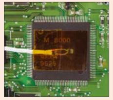
粘着性センサは平面と曲面の特定の場所に設置するのに適しています。 設置すればそのままの状態で、工作機械、電子製品、温度を監視または制御する必要がある構造や場所等の温度を測定するのに使用できます。
