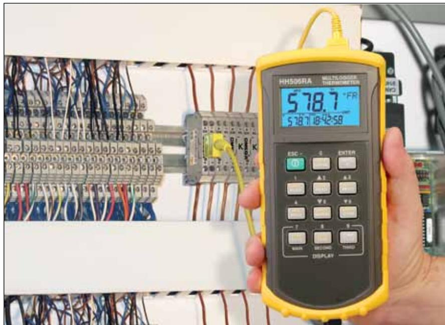
RECK1-10ケーブル、HH506RAデータロガー/温度計、RS232Cインタフェースとともに示されます。
