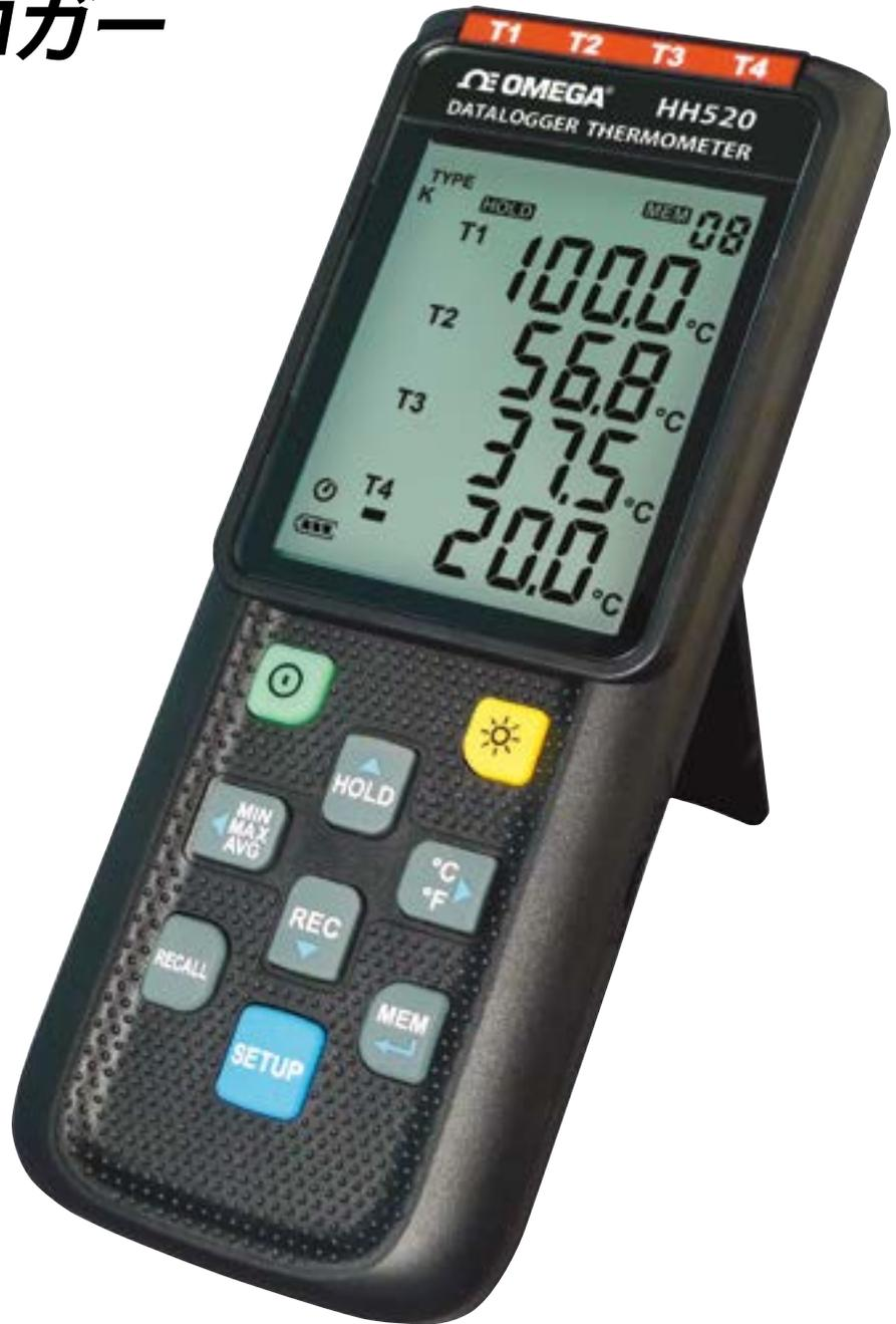
HH520はJ、K、T、E熱電対に対応する手持ち式4チャンネル温度データロガーです。測定設定と結果が、バックライト付きLCDディスプレイに表示されます。データは、データロガーに保存してからコンピュータにダウンロードすることも、USBインターフェースを介してリアルタイムでコンピュータに保存することもできます。専用ソフトウェアを使用し、PCを介して直接、データの記録/呼出し、そしてロギングパラメータのプ
