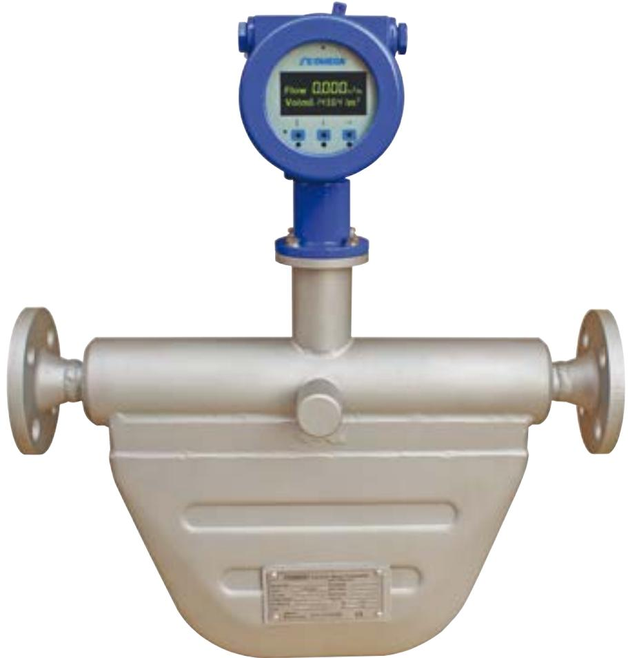
FMC-5000コリオリ式質量流量計は、コリオリ力の原理に従って設計されています。コリオリ力の原理は、多くの産業で流量測定や貨物計量に広く採用され、例えば石油、石油化学製品、化学製品、医薬品、製紙、食品／乳製品などの用途があります。FMC-5000は、先進の流量・密度測定器として、液体、気体／スラリー、および穀物の測定に広く利用され、世界中の顧客から高い評価を得ています。コリオリ測定器は通常、バッチ制御、混合、充填、投薬、貨物計量、プロセスガス測定などの用途に利用されます。
