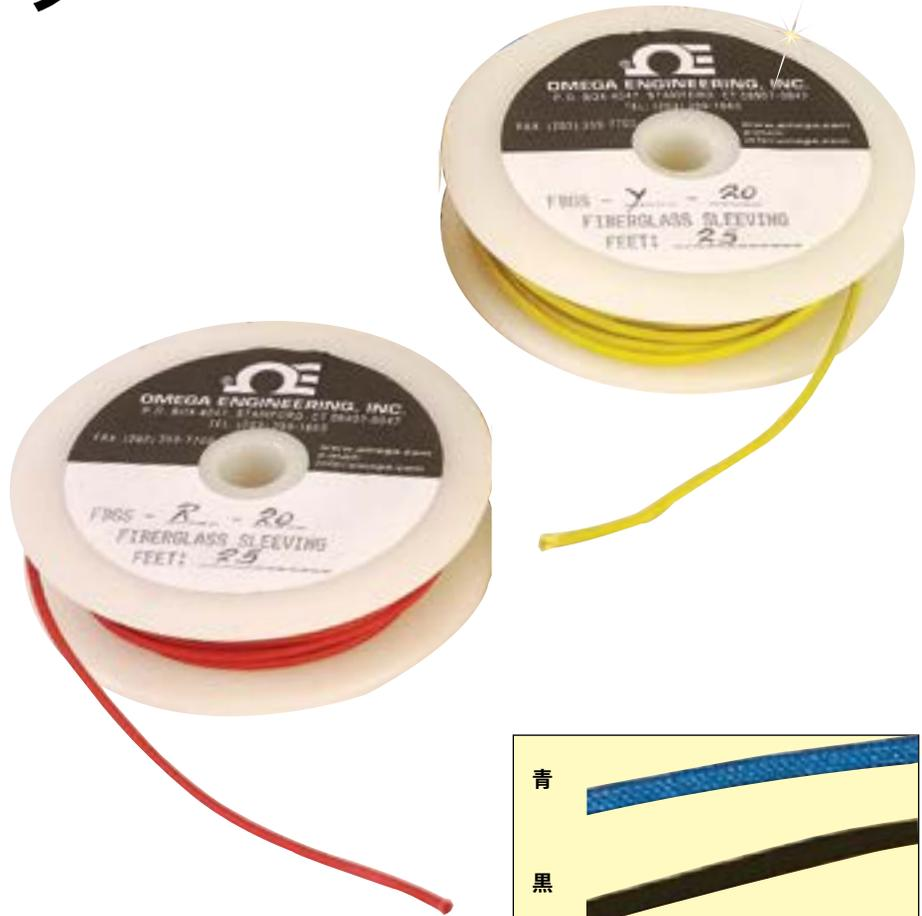
FBGSシリーズ被覆熱電対／シングルワイヤ用ガラスチューブの摩滅しないグラスファイバ製チューブは、フレキシブルで、高温用の1次または2次絶縁物になります。密に編み組みされた連続する微繊維のグラスファイバは、熱処理されて編み糸の不純物が除去されています。アクリル樹脂バインダを採用することで、色コードを使用でき、また摩滅防止効果を高め、さらに切断時にチューブの周囲を保護します。グラスファイバ絶縁部は、-60～316°Cの範囲で永久的に耐熱性があり、短時間なら最大616°Cまで耐えます。150°Cの環境にさらされると多少色落ちします。
