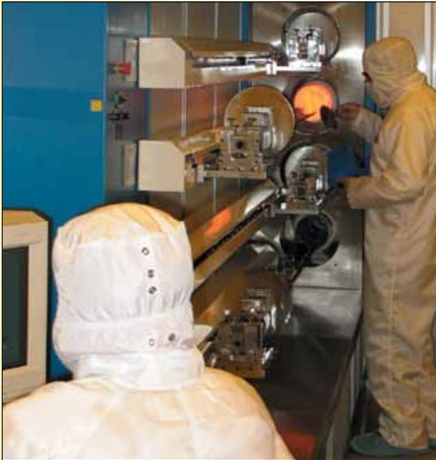
OMEGAはSuper OMEGACLAD® XL熱電対をクラス10クリーンルームで使用して、臨界温度のプロセス温度を監視することで、一貫性のある高品質の製品を得ます。
