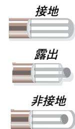
[\*]温接点タイプの指定：「G」(接地), 「E」(露出), 「U」(非接地) または「S」(表面)。[\*\*]インチで長さを指定：6, 12, 18, または24。
