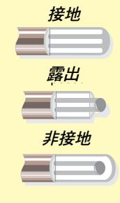
[\*]温接点タイプの指定：G (接地), E (露出), U (非接地) またはS (表面)。[\*\*]ミリメートルで長さを指定：150 mm, 300 mm, 450 mm, または600 mm。標準部品番号の最後に「-PFA」を追記して注文してください。300 mm (12") プローブ、450 mm (18") プローブ、および600 mm (24") プローブの追加費用については、[omega.com](http://omega.com)をご覧ください。200°C (400°F) 最大。注：これらの外径は成形される状態ではなく、手で組み立てられた状態です。
