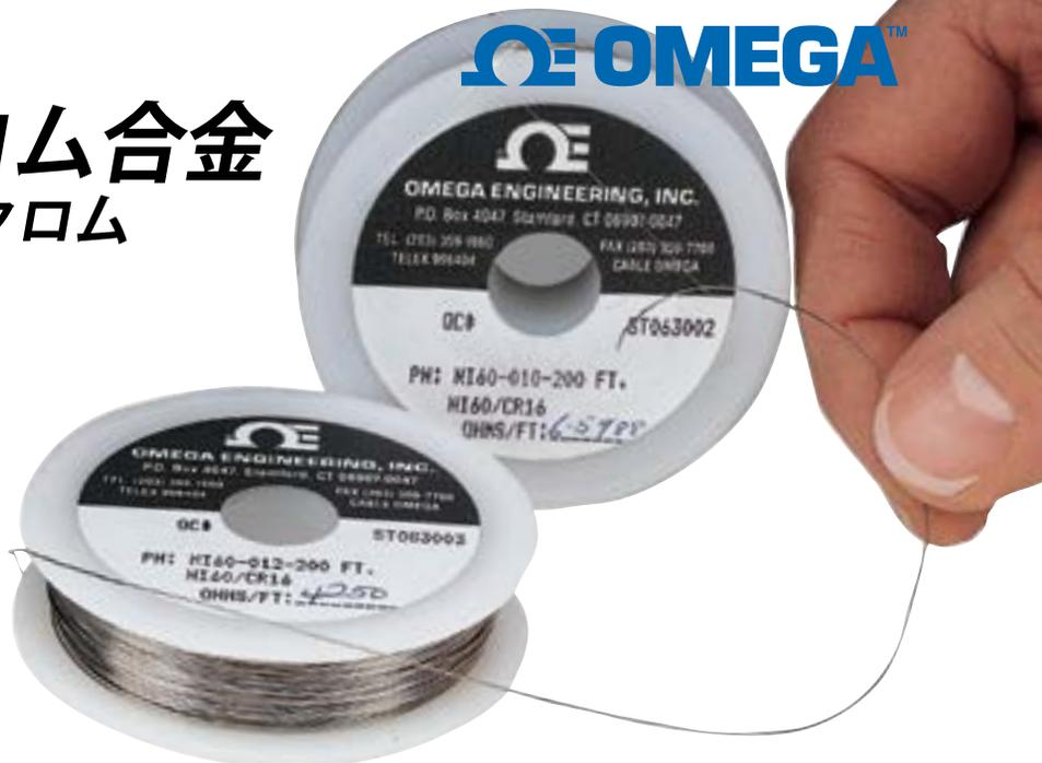
ニッケルクロム60は、電気市場において金属製抵抗線の世界標準です。ニッケル60%とクロム16%の合金で、最高1000°Cで動作する加熱装置での使用が可能です。電源コードを使用するほとんどの家庭用加熱機器がこの中に含まれ、さらに、Ni/CR-80/20 (80-20合金) ほどの高品質が要求されない中温度の加熱ユニットにも利用できます。
