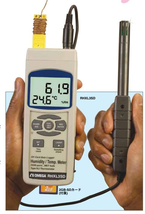
データはファイルとしてSDカードに保存され、MicrosoftのExcelで開くことができます。この機器は16 GBまでの容量のSDメモリーカードに対応しています。RHXL3SDは、バックライト付き2½"対角線ディスプレイを備え、電源として6個の単3アルカリ電池またはオプションのACアダプターで作動します。
