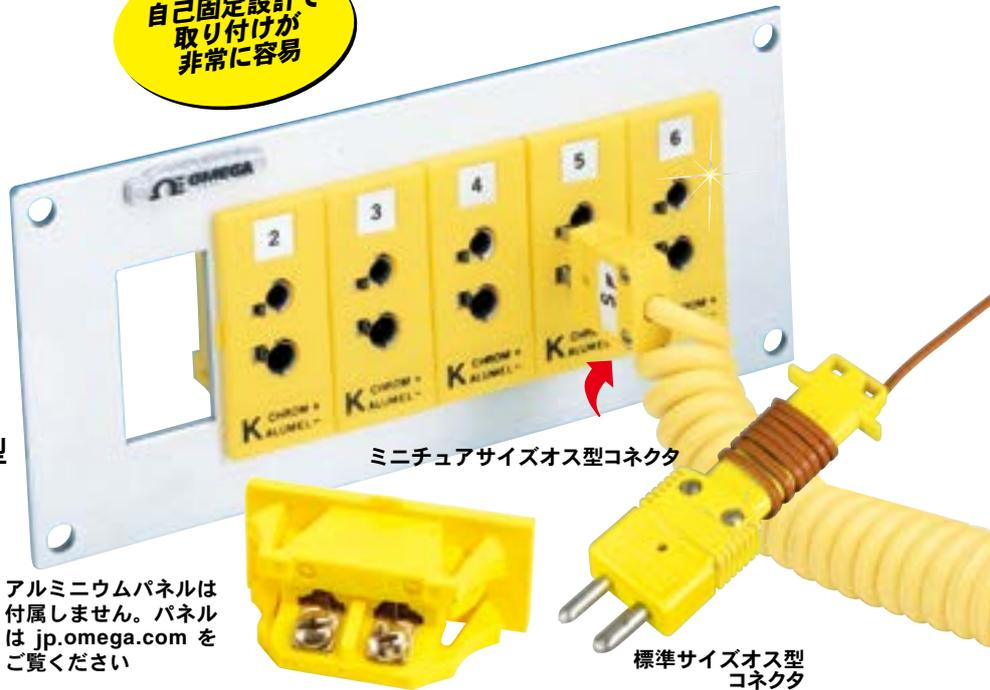
SPJ型のパネルジャックでは固定ばねがボディの一部として含まれているので、固定部品を取り付ける必要がありません。直線的で均一な列を維持するために小さなつまみと刻み目があるので、正確に合わせる必要がありません。SPJコネクタはすべての標準およびミニチュアサイズオス熱電対コネクタに対応しているので汎用タイプ熱電対に使用できます。タングステン合金C、D、Gは旧型、非汎用SPJジャックパネルコネクタでのみ使用できます。カスタマーサービスにお問い合わせください。
