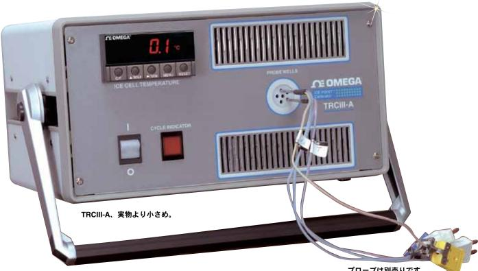
ice point™ TRCIII-A校正基準チャンバーはOMEGAの校正基準機器の優れた製品ラインの一部です。
