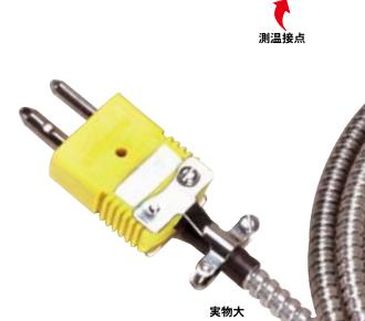
表面取り付け用の耐久型熱電対にはボルト取り付け形状、304 SS材質で17.3 mm外径の全体寸法、6.6 mm取り付け穴があります。取り付け表面に取り付けられているのは、剥き出しワイヤ端部付の1.8 mの304 SSフレキシブル外装ケーブルです。外装ケーブルは6.9 mm外径で、1.78 mmワッシャ型厚さです。標準オス型コネクタは冷接点端子用に別途注文可能です。タイプKのみで最大耐熱温度は480℃です。
